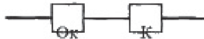
Рис. 2. Структурна схема надійності стрічки, як складної конструкції: O- верхня чи нижня обкладка; K- каркас стрічки.
