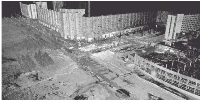
Рис. 4. Результат лазерного сканування дороги
