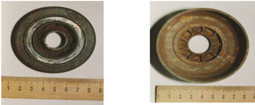
Рис. 1. Пошкодження робочого колеса і струмененаправляючого апарата відцентрових електронасосів.
